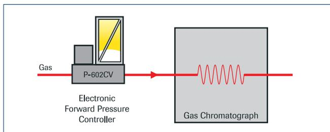
В современной газовой хроматографии предъявляются повышенные требования к автоматизации всех параметров. Регулятор давления EL-PRESS «после себя» позволяет пользователю выбирать требуемый для анализа профиль давления, в соответствие с которым давление сохраняется постоянным с очень большой точностью, даже при очень малых потоках газа.
