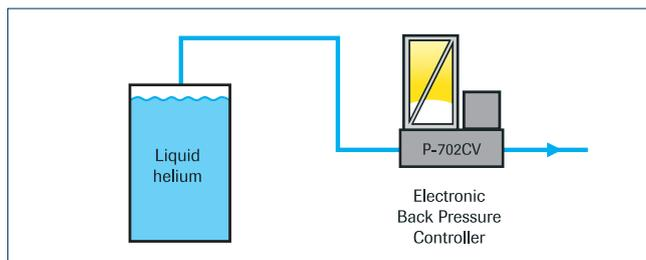
Для охлаждения сверхпроводящих катушек, используемых для генерации магнитных полей, применяется жидкий гелий. В зависимости от интенсивности температурного обмена должен происходить сброс газообразного гелия в атмосферу. При ручной регулировке изменения атмосферного давления могут повлиять на магнитное поле катушки. Регулятор давления «после себя» EL-PRESS P-702CV поддерживает постоянное давление гелия, устраняя таким образом отрицательные эффекты, вызванные колебаниями атмосферного давления.
