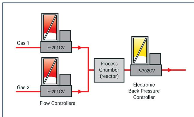
В данной схеме газовая смесь формируется с помощью регуляторов расхода EL-FLOW. В реакторе могут исследоваться эффекты влияния катализаторов на разные типы химических реакций. Давление в камере поддерживается на требуемом уровне при помощи регулятора давления EL-PRESS «до себя» независимо от полного расхода и/или состава смеси.
