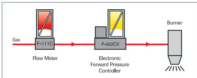
Последовательно расположенные измеритель расхода EL-FLOW и регулятор давления EL-PRESS «после себя» могут использоваться для тестирования газовых горелок, для определения зависимости емкости механических регуляторов давления от входного давления, для измерения допусков отверстий в соплах и т.д.
