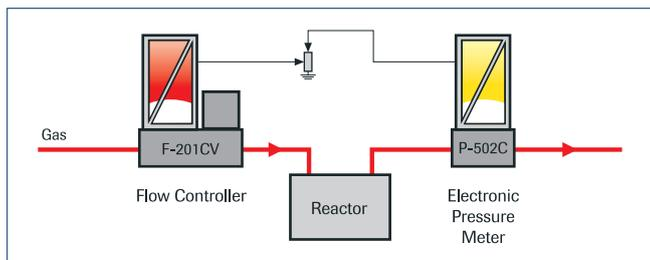
Клапан регулятора расхода EL-FLOW F-201CV может быть подключен в замкнутый контур с измерителем давления EL-PRESS P-502C, при этом измеритель расхода будет определять требуемую скорость потока для достижения заданного давления. Делитель напряжения уставки позволяет пользователю подкорректировать максимальный расход для достижения требуемых уровней давления. Данное ограничение на максимальный расход может быть использовано для обеспечения безопасности в некоторых применениях.
