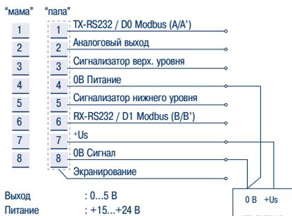
Замечание: земля питания 0 В (4 контакт), и земля сигнала 0 В (8 контакт) должны подключаться по отдельности к земле 0 В терминала источника питания.
