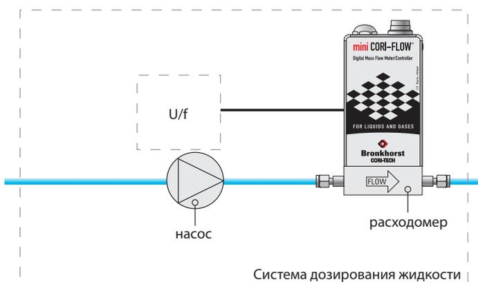
Полная серия содержит широкий спектр насосов: на расходы от очень маленьких до самых больших, для высоких давлений и для агрессивных жидкостей. В дополнение к аналоговому режиму, система дозирования может также использоваться в цифровом (через RS232 или встроенную интерфейсную плату). Благодаря простой процедуре изменения диапазона прибора с помощью цифрового интерфейса, диапазоны регулирования могут быть увеличены до 1:2000!
