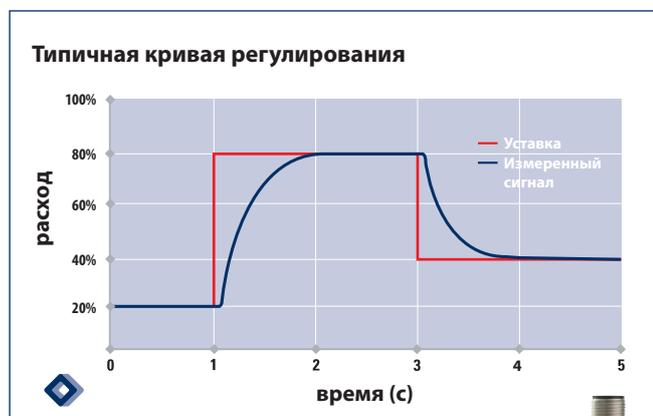
Благодаря чрезвычайно быстродействующему сенсору (50...200 мс) стало возможным достижение очень быстрого регулирования, в том числе при дозировании.
