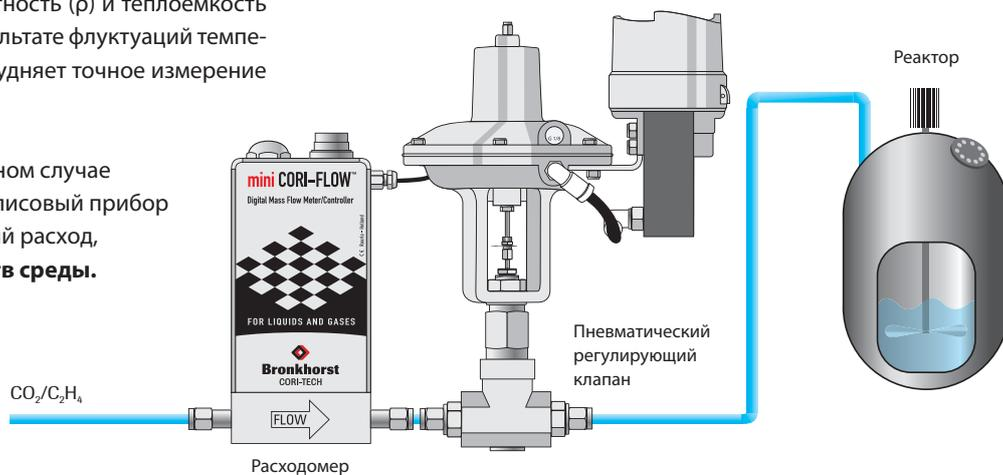
mini CORI-FLOW™ с пневматическим регулирующим клапаном
