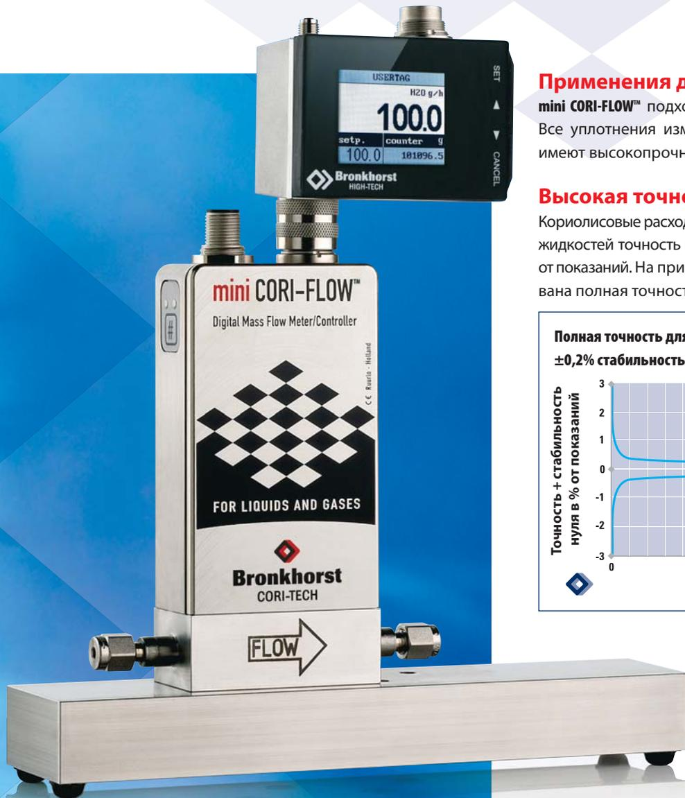
Расходомер mini CORI-FLOW™ с локальным считывающим модулем, закрепленный на дополнительном массивном основании
